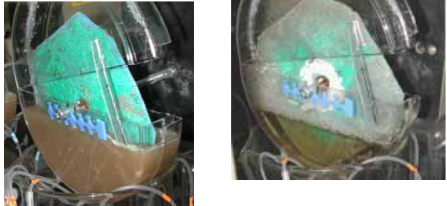
図1 しょうちゅう粕(麦)を用いた簡易処理試験 左図：処理前、右図：処理後
