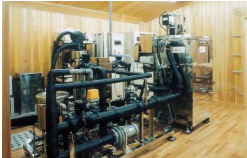
麹造りの研究に使用する小型製麹装置 酒類総合研究所広島事務所
