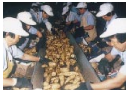
甘藷の原料処理。不良部分をカットし良質部分だけが焼酎の仕込みに使われます。
