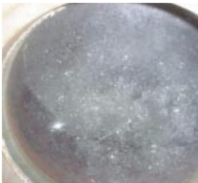
連続式蒸留機内で精製されるアルコール。水を加えて焼酎甲類が製造されます。
