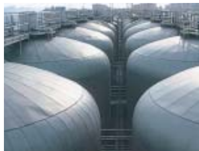
低温で若ビールを熟成しておいしいビールに仕上げます。
