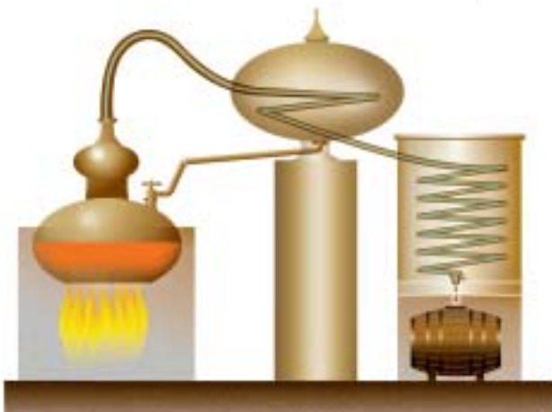
単式蒸留機のしくみ
