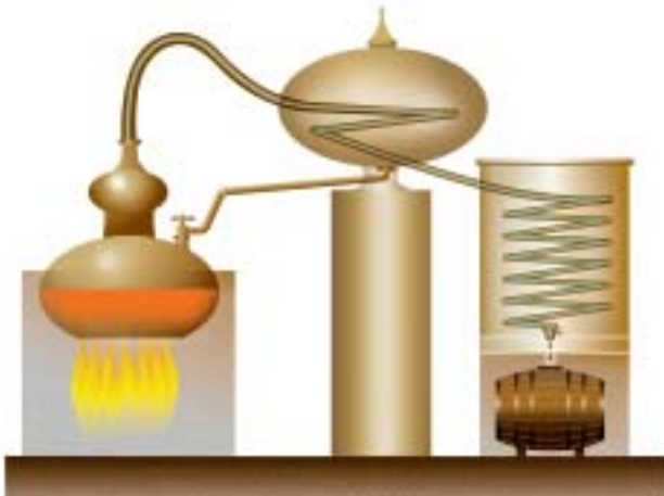
単式蒸留機のしくみ
