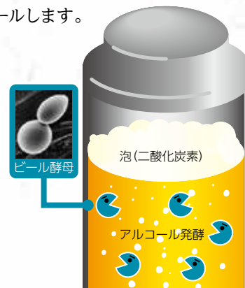
苦味と香りを付けた麦汁に酵母を添加して、アルコール発酵させます。
