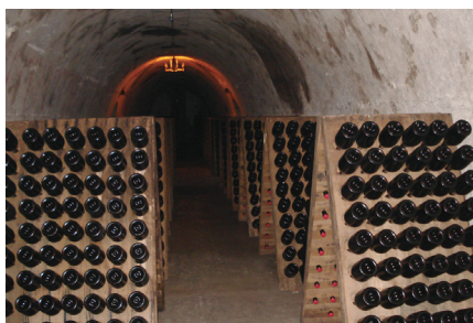
(ピュピトルと呼ばれるラックにたてて沈殿物を口元に集めます)
