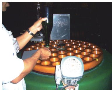
(びんの口先を凍結させる機械)
