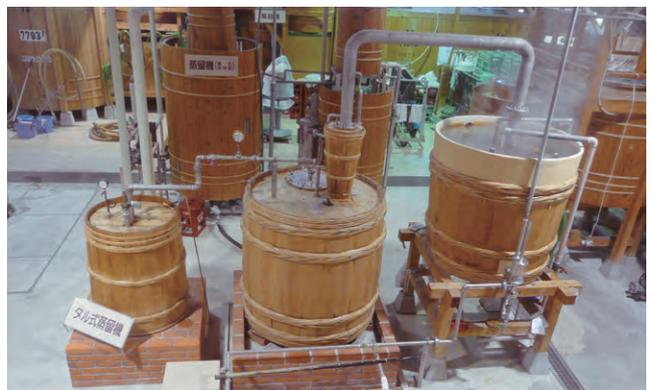
木樽製の蒸気吹込み式蒸留機
