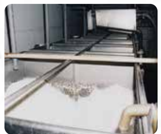
自動洗米機。洗いと吸水時間を調節します。
