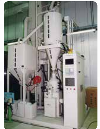
自動化された精米機。職人の経験がコンピューターに入力され精米します。
