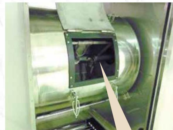
回転ドラムで米を洗います。次の日、米を蒸し、温度調節をしながらドラムの中で麴を造ります。
