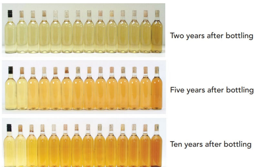
Figure 1. 1999 年 AWRI クロージャ試験の結果。瓶詰 2 年、5 年、及び 10 年後に着色が少ないものから多いものへ並べた。
