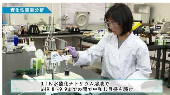
0.1N水酸化ナトリウム溶液で pH9.8~9.9までの間で中和し目盛を読む
