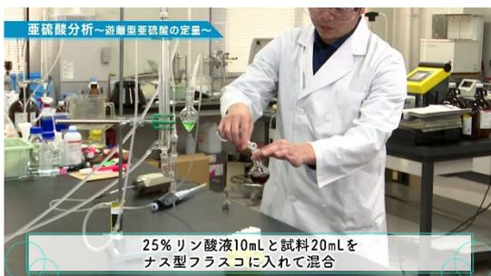
25% リン酸液10mLと試料20mLをナス型フラスコに入れて混合
